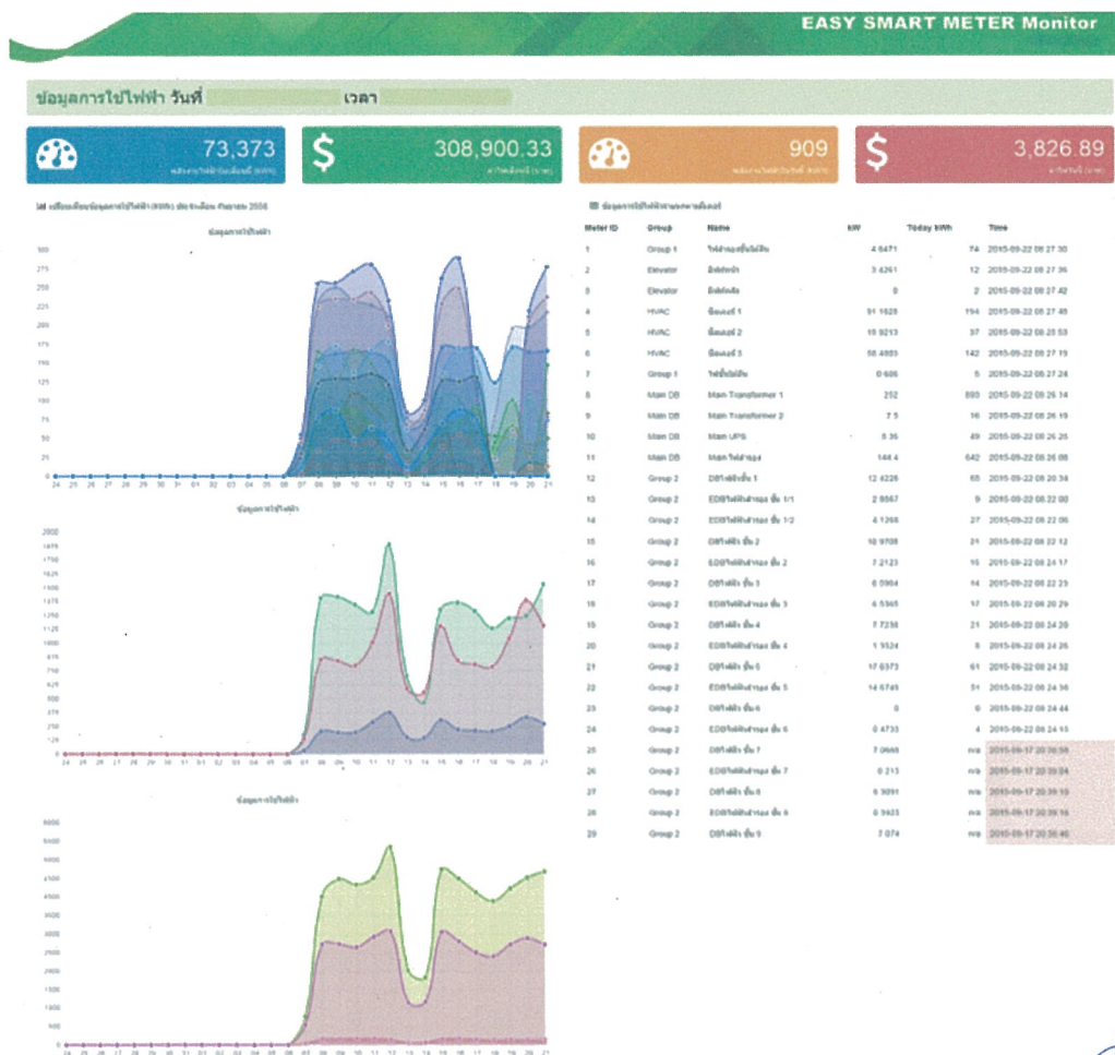
ภาพที่ 9 ตัวอย่างการแสดงผลปริมาณการใช้พลังงานของระบบตรวจติดตามและแสดงผลการใช้พลังงานไฟฟ้า
